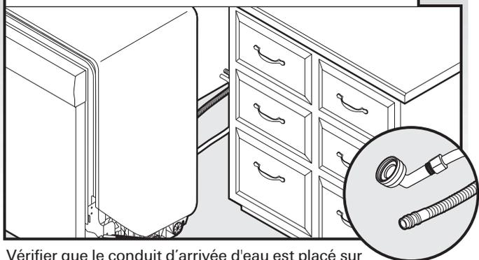
Vérifier que le conduit d'arrivée d'eau est placé sur le côté gauche de la cavité et que le tuyau d'évacuation est placé près du centre de la cavité.
